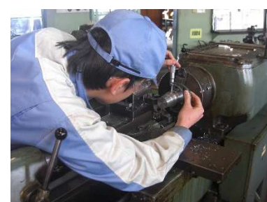
マイクロメータによる外形測定
