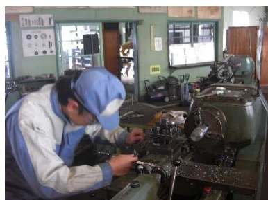
超鋼チップ交換作業
